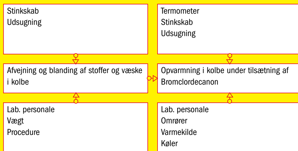
Figur 1. Eksempel på funktionel modellering. Fremstilling af phenyl-10-bromdecanon i stinkskab.
