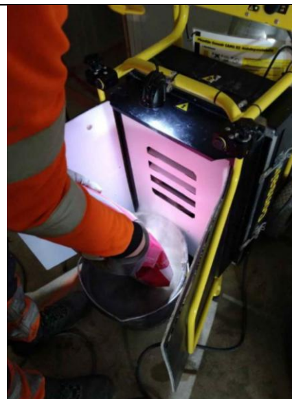
Figur 3-10. Mobilt punktsug (fra Tuomi et al. 2022).
