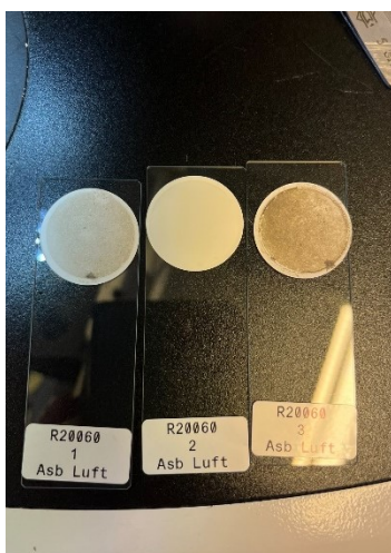
Billede 5—1. Forskel i støvmængden på stationære filtre
