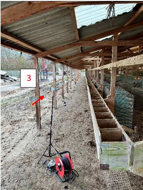
Billede 4—19. Placering af stationære målinger på minkfarm projekt 3 ved morgens-og middagsrunde. To målinger (1 og 2) er placeret langs den ene side af taget hvor arbejdet foregik og en på modsat side (3).
