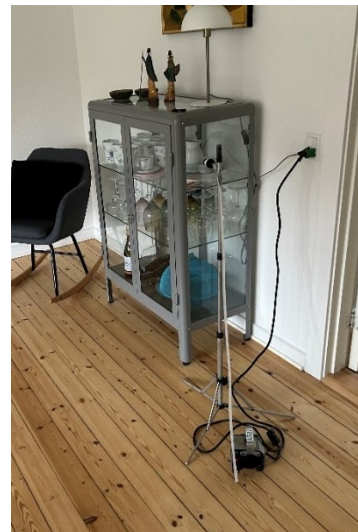
Billede 4—29. Eksempel på kontrol af rengøringsstandard med stationær luftmåling efter sanering en bolig.
