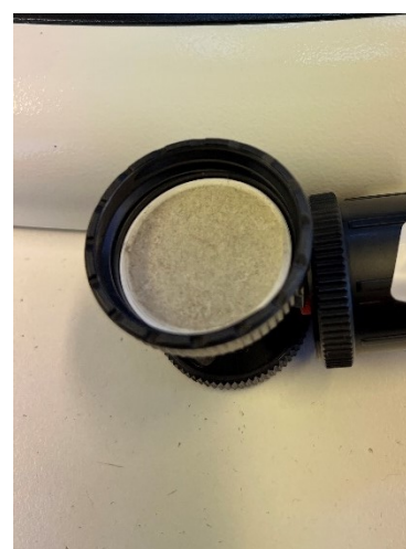
Billede 5—3. Filter fuldstændig dækket af støv.
