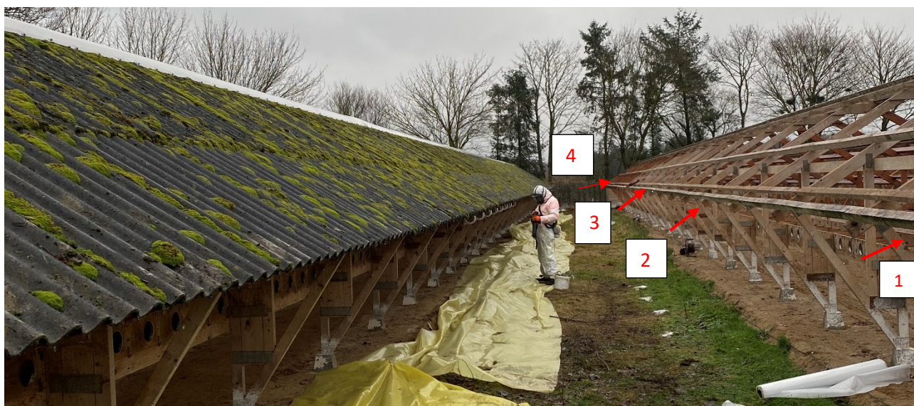
Billede 4—17. Placering af stationære målinger på minkfarm projekt 1. Fire målinger er placeret langs den side af taget hvor arbejdet foregik (røde piller). De to sidste målinger (5 og 6) er i næste række, på begge sider af arbejdsområdet.
